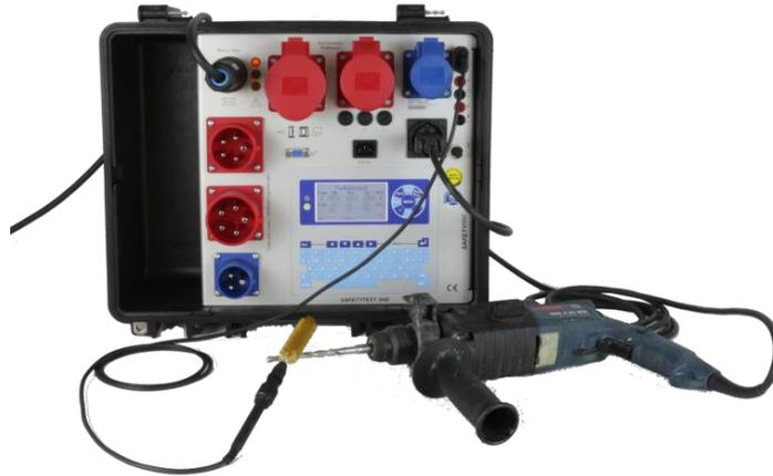
**Messung an berührbaren Teilen, die nicht mit PE verbunden sind:** Mit der Sonde diese Teile abtasten. Bei sich bewegenden Teile, wie bei einer Bohrmaschine, das Bohrfutter im drehenden Betriebszustand abtasten, am besten mit der optionalen Bürstensonde.
