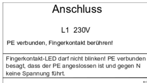
Im ersten Menü „Anschluss“ werden die vorhandene Netzspannung sowie die Qualität des N- und PE-Leiteranschlusses angezeigt.
