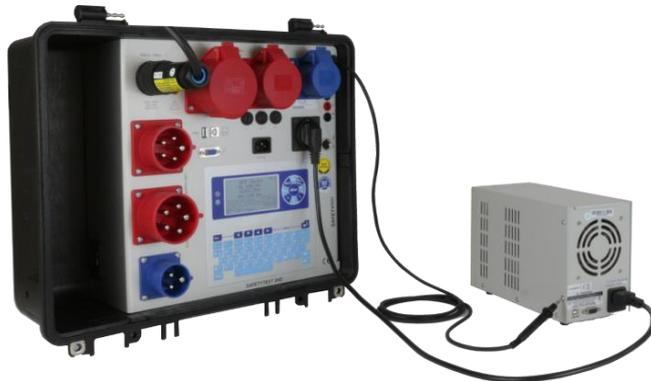
**Schutzleitemessung:** Mit der Schutzleitersonde die Gehäuseteile abtasten und Anschlusskabel bewegen.
