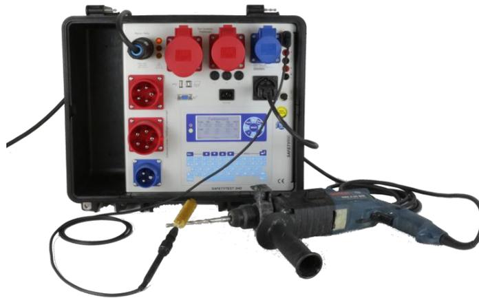
**Messung an berührbaren Teilen, die nicht mit PE verbunden sind:** Mit der Sonde diese Teile abtasten. Bei sich bewegenden Teilen, wie bei einer Bohrmaschine, das Bohrfutter im drehenden Betriebszustand abtasten, am besten mit der optionalen Bürstensonde.
