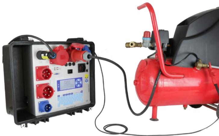
Stecker des Prüflings anpassende Prüfdose anschließen. Mit der Sonde die geerdeten Metallteile des Prüflings abtasten.
