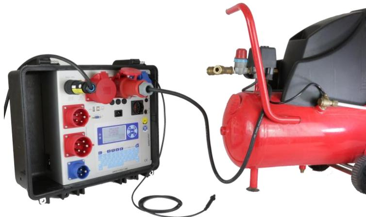
Prüfablauf: „Mit Iso-Messung“ > Ja. Stecker des Prüflings an Prüfdose des Messgerätes anschließen. Den Prüfling einschalten.
