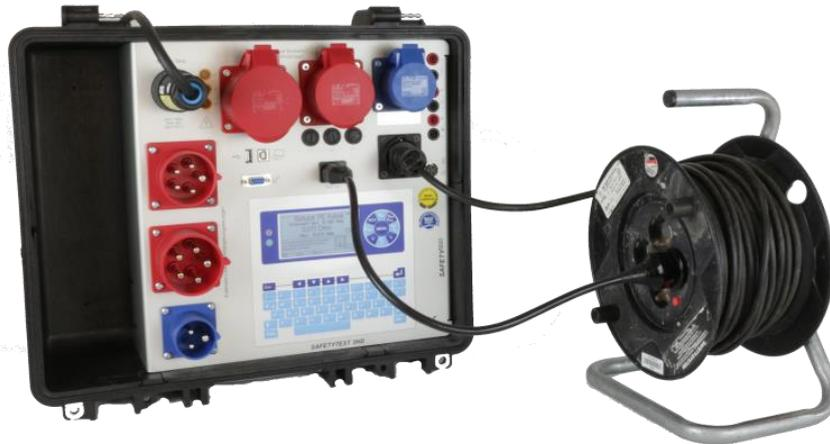
Für die Messung einer Verlängerungsleitung/Kabeltrommel (einphasig) wird der Schukostecker des Prüflings in das Prüfgerät gesteckt. Die andere Seite der Verlängerungsleitung wird mit dem Einbaustecker „RCD Test“ verbunden.
