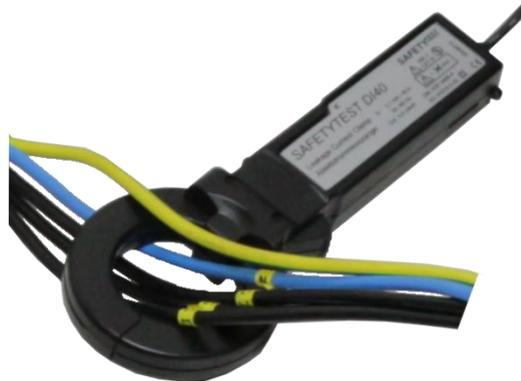
Die Zange am Prüfgerät (Buchse schwarz und rot mit Zangensymbol gekennzeichnet) anschließen. Mit der Differenzstromzange die Leiter L1, L2, L3 und N umfassen.
