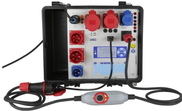
Bei der RCD/PRCD/PRCD-S/PRCD-K Prüfung wird der Schukostecker in die Prüfdose des Prüfgerätes gesteckt. Die andere Seite der RCD-Leitung wird in den Einbaustecker "RCD Test" gesteckt, gegebenenfalls unter Verwendung eines Adapters gemäß der Abbildung.
