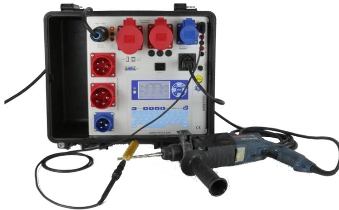
**Messung an berührbaren Teilen, die nicht mit PE verbunden sind:** Mit der Sonde diese Teile abtasten. Bei sich bewegenden Teilen, wie bei einer Bohrmaschine, das Bohrfutter im drehenden Betriebszustand abtasten, am besten mit der optionalen Bürstensonde.
