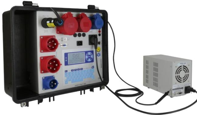
**Schutzletermessung:** Mit der Schutzleitersonde die Gehäuseteile abtasten und Anschlusskabel bewegen.
